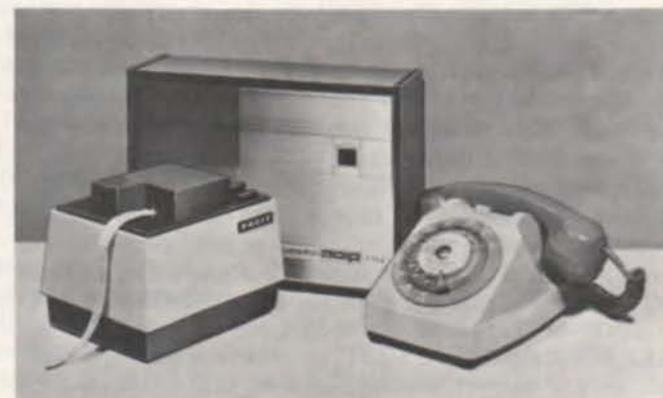
L'émetteur transmet un message codé à 8 chiffres permettant d'identifier l'émetteur et l'alarme.
