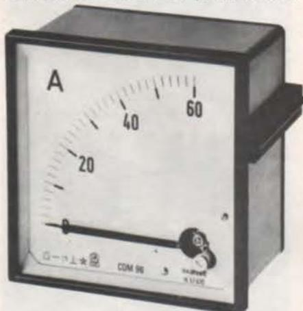
La calotte frontale de protection de tous les instruments est soumise à un traitement anti-statique. Les appareils ferromagnétiques sont livrables avec calibres de 1 A jusqu'à 1 000 A (au-delà de 80 A avec un transformateur d'intensité avec enroulement secondaire de 5 A) et de 50 à 500 V (pour des tensions plus élevées, on utilisera un transformateur de tension avec enroulement secondaire de 100 V).
