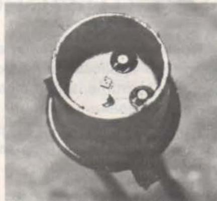
Un transistor planar (ici un BC 109) dont on a ouvert le boîtier constitue un excellent photo-transistor non directif.
