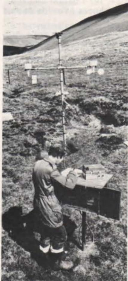
diaires les cartes enfichables de traitement de signaux des capteurs, l'affichage par L.E.D. et tous les capteurs. L'enregistreur convertit en numérique les signaux d'entrée et les enregistre sous forme de mots de 8 bits en mode différentiel à intervalle réglable de 2 s. à 1 h.
