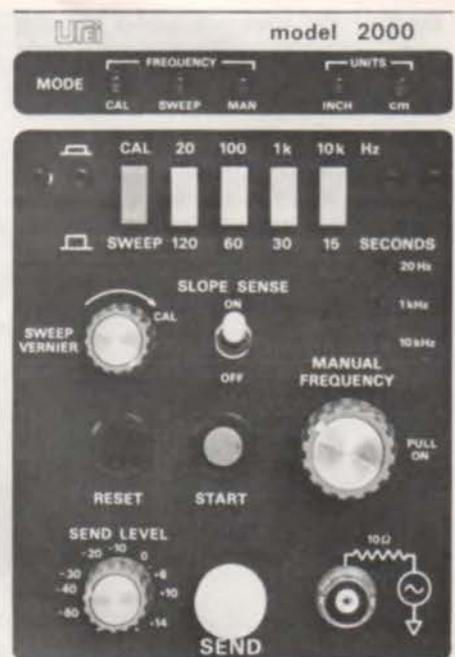
Les commandes, section générateur. En haut, les voyants à diode LED, sélection de vitesse et de calibration, vernier de vitesse et mise en service du détecteur de pente, boutons de départ, commande de fréquence manuelle, niveau de sortie, vis de blocage du tiroir.
